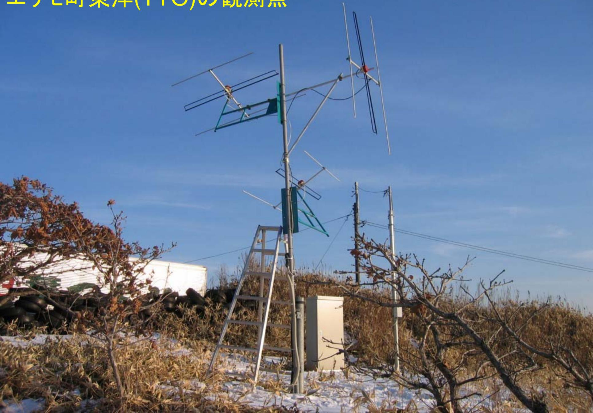
1月23日日高山脈南部M4.6の前13日に観測された散乱波では、広尾(垂直偏波発信)からの散乱波はエリモと留崎の水平アンテナに観測されたが垂直アンテナには観測されなかった。
